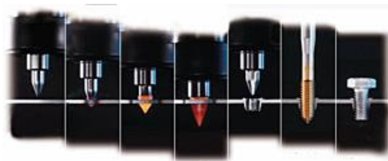
Figuur 6: proces vloeiboren [34]
