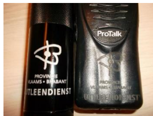
Figuur 43: Lasergravering op diverse materialen [1]
