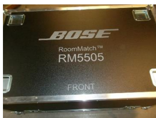
Figuur 44: Lasergravering op flightcase [1]
