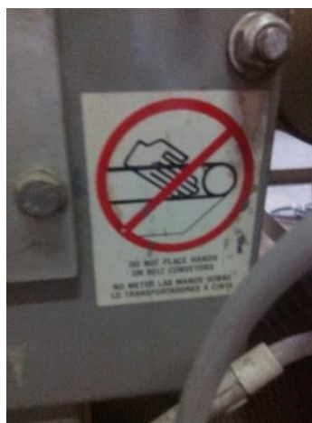
Figuur 10.A: Pictogram verboden om de handen in de machine te plaatsen
