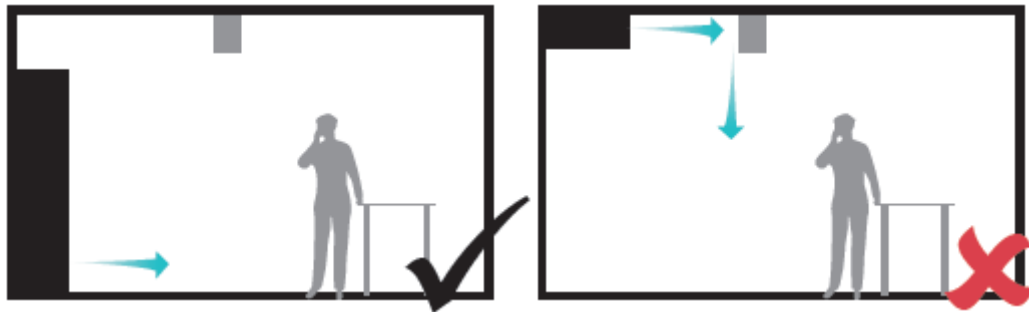
Figuur 40: Uitleg bij de plaasting van de Airmaster ventilatiesystemen [15]
