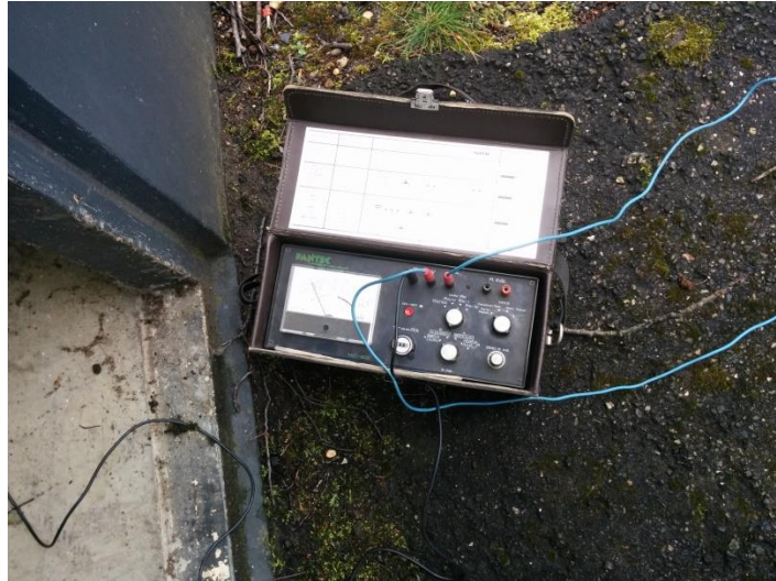
Figuur 28: meten spreidingsweerstand
