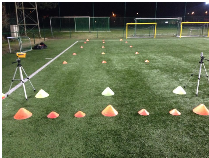
Figuur 5: Opstelling HSV test met de 2 banen en meetapparatuur
