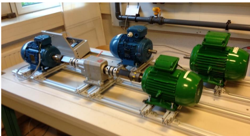
Figuur 30: Motor-generator opstelling, vaste opstelling, dubbel
