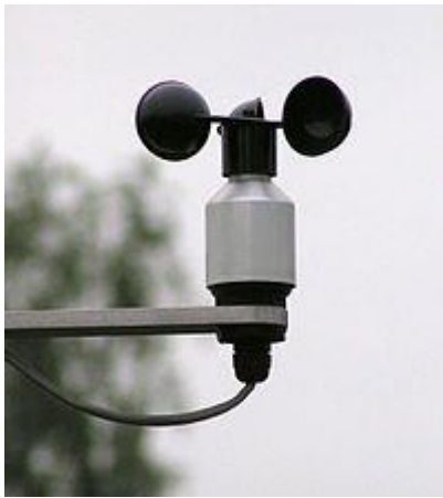
Figuur 2: Anemometer met halve bollen [4]
