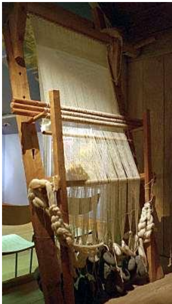
Afb. 37 Verticaal weefgetouw zoals Scandinavische vrouwen het gebruikten
