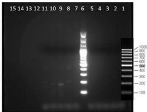
Figuur 7 Gelelektroforese met Retschmixer i.p.v. de Agilent vortex. 1) 1x geautoclaveerd, 2) 2x geautoclaveerd, 3) 3x geautoclaveerd, 4) 4x geautoclaveerd, 5) 5x geautoclaveerd, 6) Ladder 100 bp+, 7) grasstaal Uhasselt 1, 8) grasstaal Uhasselt 2, 9) grasstaal Uhasselt, 10) Niet-geautoclaveerd bodemstaal 1, 11) Niet-geautoclaveerd bodemstaal 2
