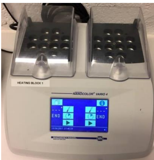
Figuur 12: NANOCOLLOR® Vario 4 heating block voor de verwarming van test-tubes voor een aantal analyses
