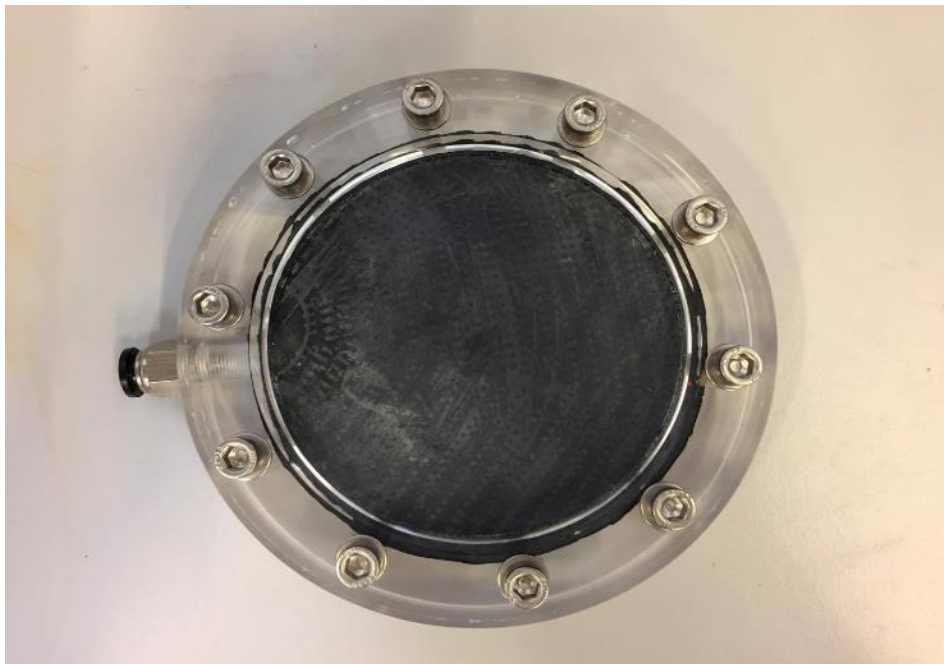
Figuur 9: Beluchtingschijf voor de beluchting. Er is in elke compartiment één schijf aanwezig. Door de kleine poriën in de schijf wordt de lucht in de reactor gebracht
