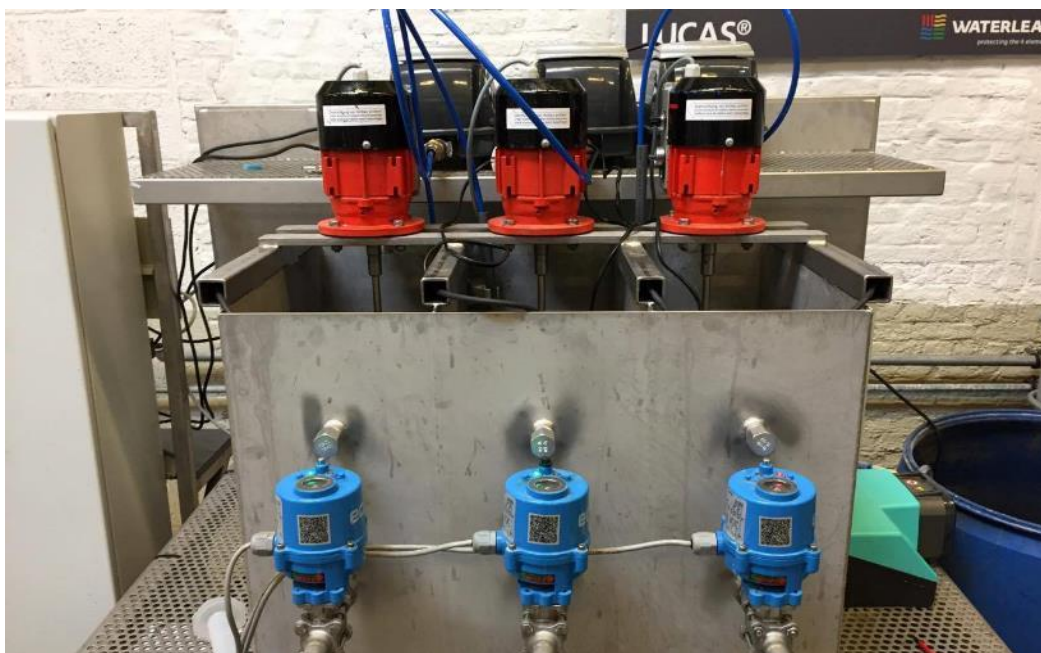
Figuur 7: LUCAS ® -3 pilotreactor opstelling. Bovenop de reactor staan de mixers (rood) die voor een continue menging van de reactor zorgen waar nodig
