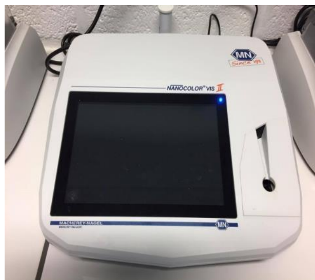
Figuur 11: de NANOCOLLOR® VIS II spectrofotometer voor de spectrofotometische concentratie bepalingen van verschillende componenten
