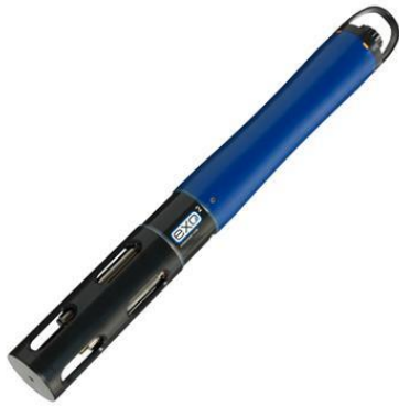
FIGUUR 18: MULTIPARAMETERSONDE EXO2 (YSI, 2017)
