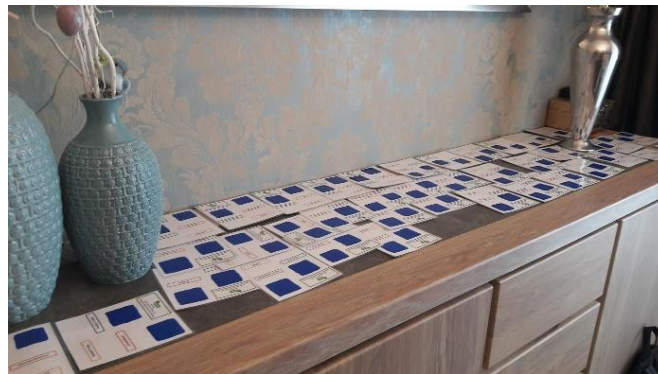
Figuur 35: De QR-codes werden bedekt met verf. (Bollen, A., 2018)
