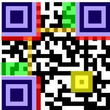
Figuur 16: Verschillende onderdelen van een QR-code [5]
