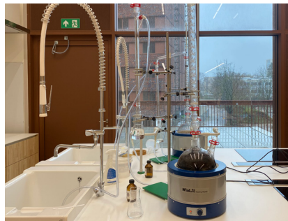
Figure 6. Yang Xu, distillation setup, 2021.
